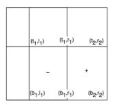
$$\text{Haar}(t_1, l_1, b_1, r_1, b_2, r_2) = \text{ii}(b_2, r_2) - 2\text{ii}(b_1, r_1) + \text{ii}(b_1, l_1) - \text{ii}(t_2, r_2) + 2\text{ii}(t_1, r_1) - \text{ii}(t_1, l_1)$$
