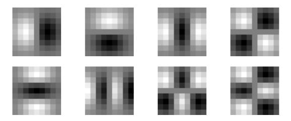
The Gaussian receptive fields  $G_{x_1}G_{y_2}$ ,  $G_{xx_3}$ ,  $G_{xy_2}$ ,  $G_{yy_3}$ ,  $G_{xx_4}$ ,  $G_{xx_5}$ ,  $G_{xy_5}$ ,  $G_{yy_5}$ .
